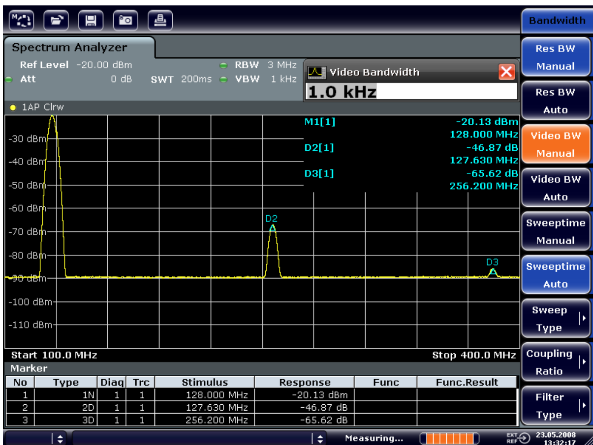
Bild 6-3: Rauschunterdrückung bei der Oberwellenmessung durch Verringerung der Videobandbreite
